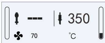
-Heißluft befindet sich in Standby -LötKolben ist in Betrieb
