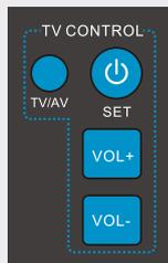
Die Fernbedienung verfügt über 4 Tasten zur Programmierung eines TV's.
